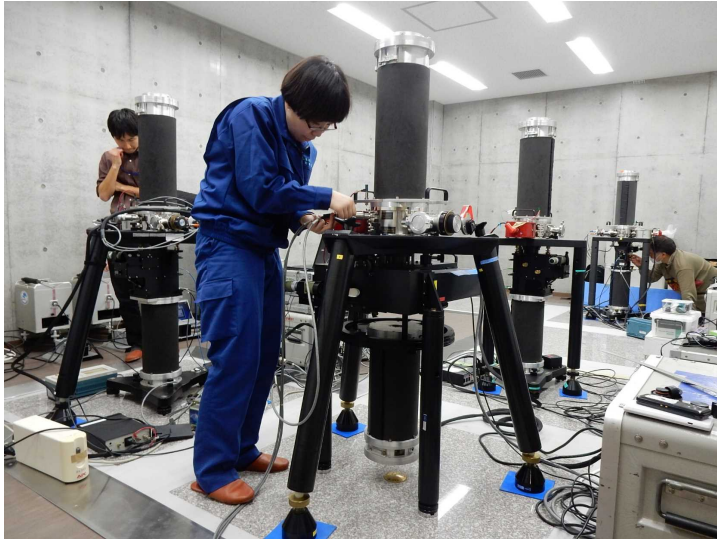
絶対重力測定（FG5絶対重力計）
