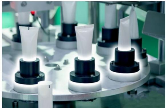
搬送治具が破損しても造形してすぐに復旧しダウンタイムを最小化できます。また、靱性の強い樹脂は破損を防げるだけでなく、商品の意匠面を傷つけたくない場合にも有効です。
