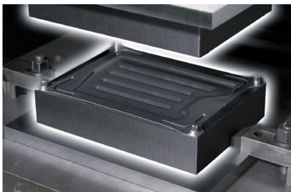
金型作製の形状確認はもちろん、大きな荷重や熱に耐えられる樹脂はプレスの金型や射出成型型としても使用可能。少量多品種の生産に対応します。
