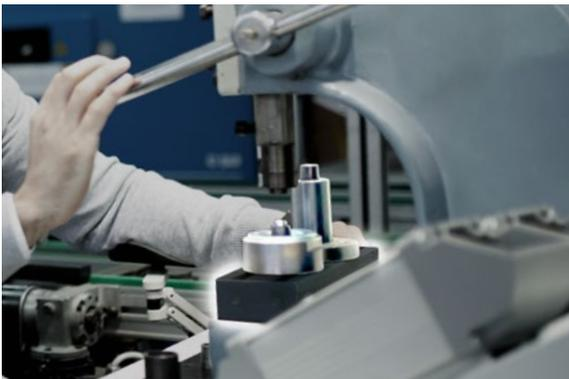
従来の3Dプリンタで作った治具を圧入・圧着治具に使用すると荷重で割れが発生していました。GXシリーズの高機能樹脂であれば割れることなく安心して使用できます。
