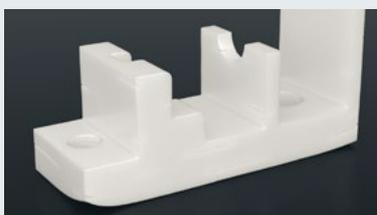
樹脂と樹脂が定着せず隙間が生まれます。庫内温度が途中で変化したときやノズル温度が樹脂に対して適正でないときに発生します。
