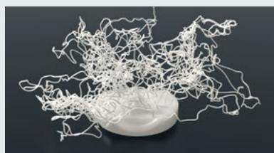
定着不良で造形物がテーブルから剥がれます。庫内温度が途中で変化したときや機械の調整がうまくできていないときに発生します。
