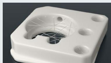
ノズル内の樹脂が自重で垂れて造形されます。樹脂が吸湿していたり、ノズル温度が樹脂に対して適正でなかったりするときに発生します。
